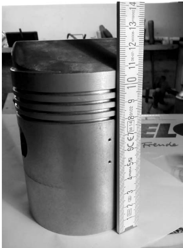
Nový píst A 50 s mazacími otvory
